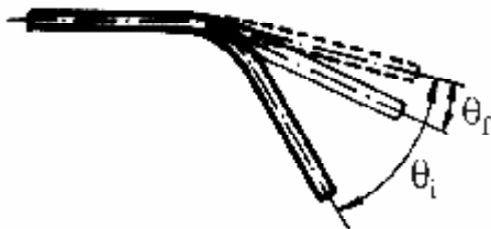
Fig. 3.1. Schemă explicativă pentru metoda de determinare a gradului de recuperare a forme prin măsurarea unghiului de încovoiere, [103].
