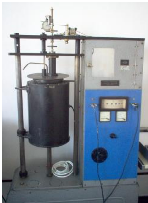
Figura 2.14. Dilatometru diferențial adaptat pentru testarea probelor cu dimensiuni mari, supuse la tracțiune [151].
