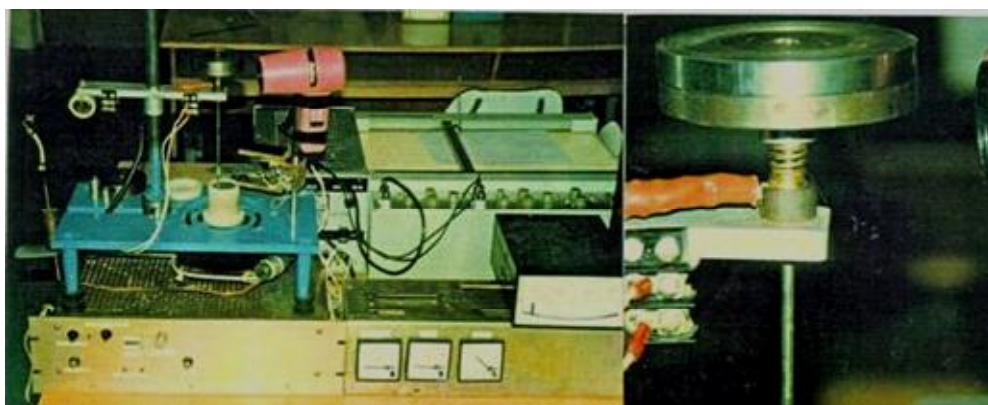
Fig. 3.23. Fotografia instalației experimentale de educare a arcurilor elicoidale cu memoria formei: a – imagine de ansamblu; b – detaliu ilustrând arcul din AMF montat în dispozitivul de educare.
