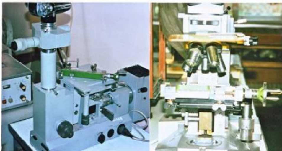
Fig. 3.19. Dispozitivul pentru studierea martensitei induse prin tensiune instalat în poziție de vizualizare pe lățimea epruvetei: a) instalat pe microscopul Karl Zeiss Jenna echipat cu sistem de poziționare a probei deasupra obiectivului; b) instalat pe microscopul IOR MC9, cu poziționare sub obiectiv, [143].
