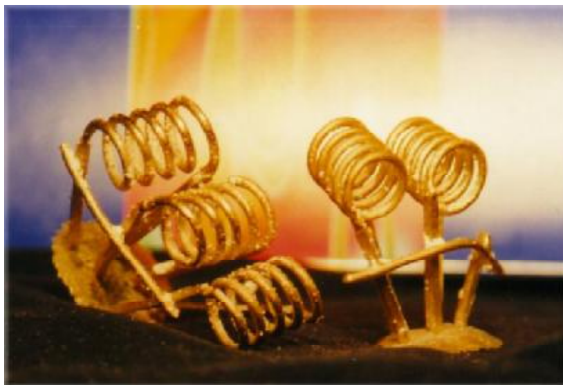
Fig. 4 13. Arcuri brut turnate înainte de curățire.
