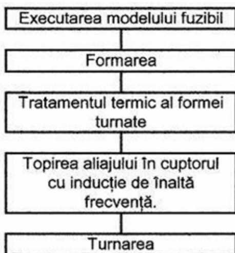
Fig.4.8. Etapele tehnologiei de obținere a arcurilor cu memoria forme direct din topitură.
