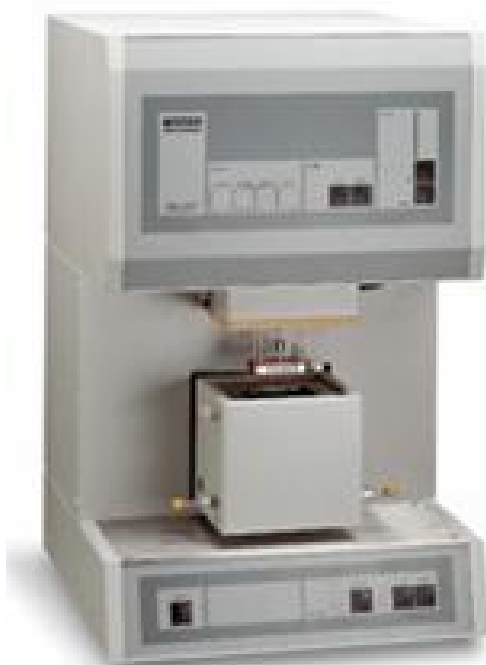
Fig. 3.32. Echipament de investigație a proprietăților mecanice tip DMA (model DMA 242c de la firma Netzsch).
