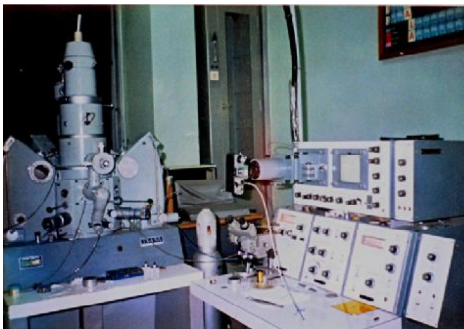
Fig.3.22. Microsonda electronică JXA - 5A JEOL - JAPONIA cu spectrometru WDX utilizată pentru analiza structurală a aliajelor experimentale.
