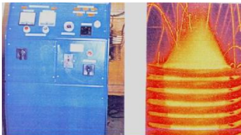
Fig. 4.11. Agregat de elaborare a aliajelor pentru turnarea arcurilor elicoidale cu memoria formei: a - cuptorul cu inducție de înaltă frecvență; b - ansamblul formă de turnare-inductor în timpul topirii.
