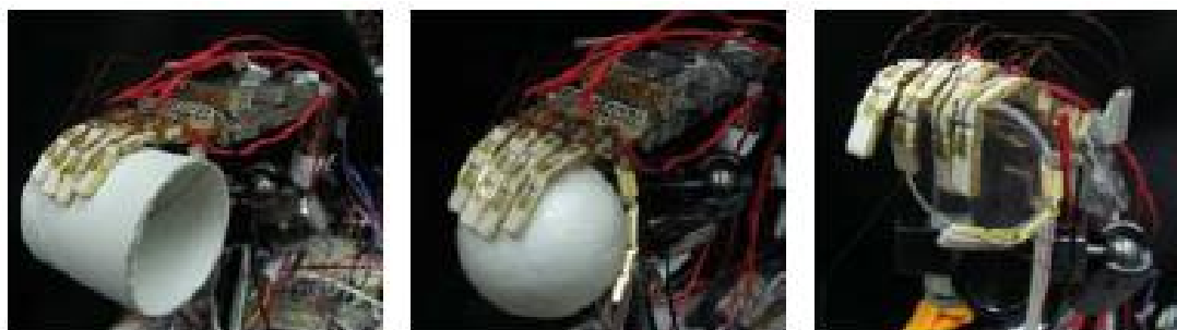
Fig. 2.37. Ilustrarea testului de prindere în forță a unor obiecte [154].
