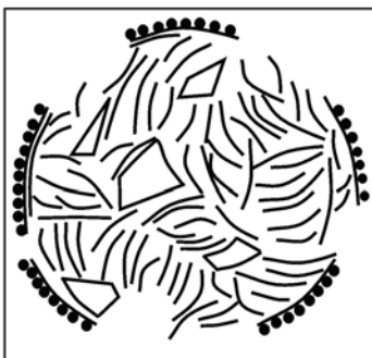
Fig. 13. Schița unui agregat policristalin la începutul intervalului de solidificare, în circumstanțele unei cantități mai mici de element F_j remanent; \cdot – atomi de modifikator.
