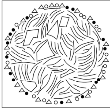
Fig.59. Nodul de grafit obținut prin modificarea fontei cu un modulator care conține Ca, Ce și Mg. ○ – particule de Ca; ● – particule de Mg; r – particule de Ce; fondul alb din jurul nodului de grafit reprezintă matricea metalică.
