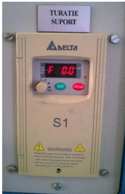
Fig. 5. Dispozitiv comandă motor electric și reglare turație suport
