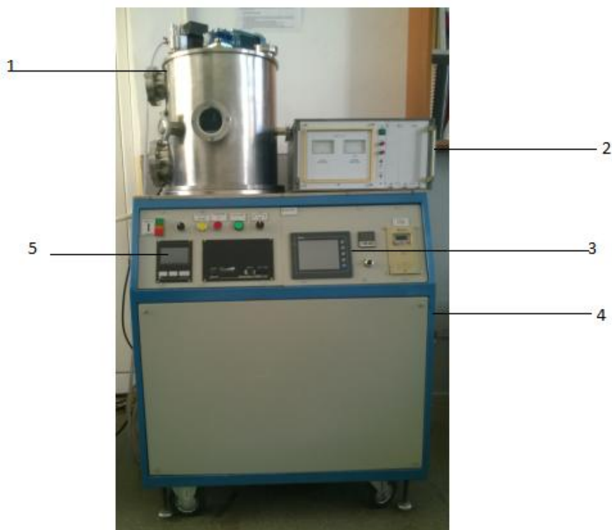
Figura 1. Instalație de laborator pentru realizarea depunerilor de straturi subțiri în vid
