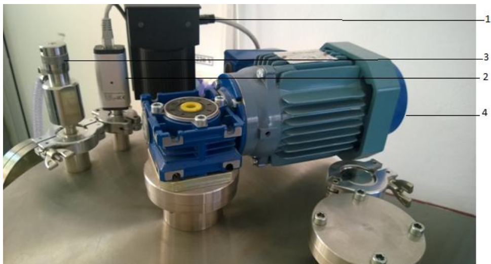
Fig. 3. Dispozitivele de pe capacul incintei de vid: 1,2 – traductori de presiune, 3- ventil micrometric (robinet mecanic) pentru debit scazut de reglare a presiunii de gaz (plasmagen sau reactiv), 4 – motor electric de acționarea a sistemului rotativ de suport al probelor
