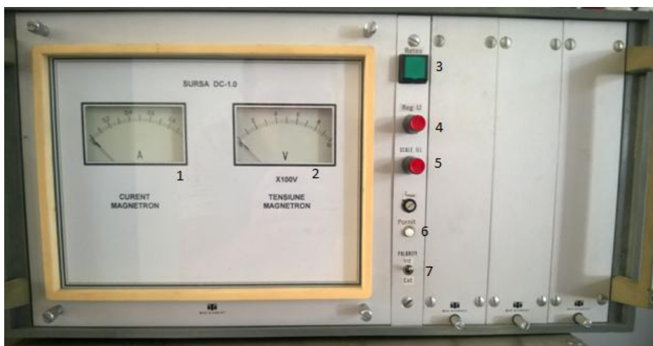
Fig. 10. Sursa de curent continuu: 1 – ampermetru, 2 – voltmetru, 3 – buton comandă legare la rețea, 4 – buton reglare tensiune, 5 – buton reglare current, 6- buton pornire, 7-buton schimbare polarizare;
