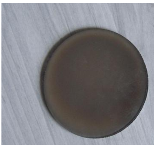
Fig.7. Substrat cu peliculă de titan depusă prin pulverizare catodică în regim magnetron cu instalația de laborator
