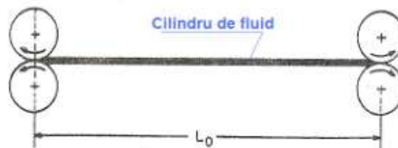
Fig.1.12 Dispozitive rotative utilizate pentru deformarea la întindere uniaxială a unui filament cilindric de polimer de lungime L_0
