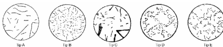
Fig.4/F9. Formele tipice de grafit conform standardului S.U.A.: tip A – lamelar dezorientat; tip B – rozete; tip C – grafit specific fontelor hipereutectice; tip D – grafit fin, punctiform, interdendritic de subrăcire; tip E – grafit fin lamelar, orientat, interdendritic
